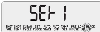
5. Drehwähler SELECT auf die gewünschte, zu programmierende Einstellung drehen: „Set 1“ (Einstellung 1) bis „Set 6“ (Einstellung 6). Für bereits programmierte Einstellungen wird ein Tassen-Symbol angezeigt.
